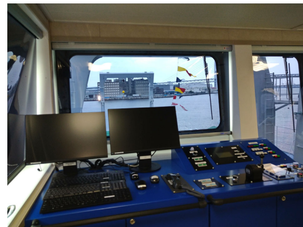
船尾のクレーンと荷役機器のコントロール室
