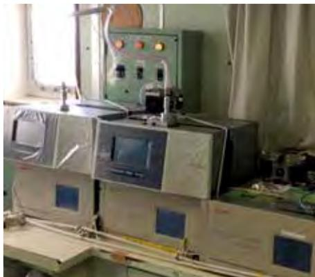
図 1 深江丸に搭載している大気質測定機器
