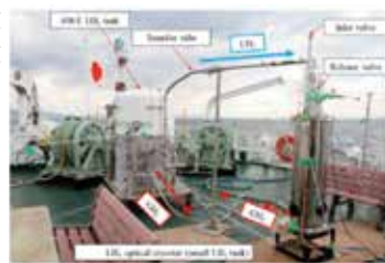
図4 深江丸による液体水素海上輸送実験の写真
